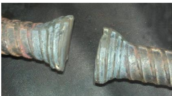
شکست آرماتور جوشکاری پس از رها شدن از دست
