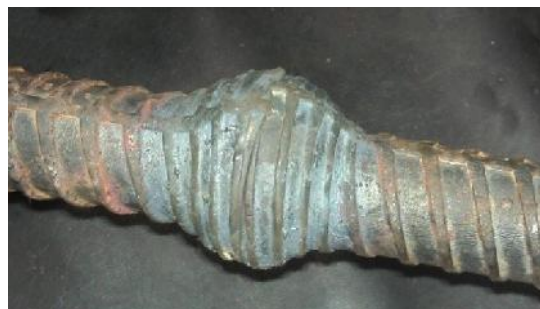
آرماتور جوش کاری شده به روش Gas pressure welding
